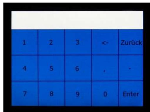
Die einzelnen Zahlenfelder müssen separat eingestellt werden. Die angezeigte Zahl muss zuerst mit dem ← Symbol gelöscht werden. Nun die gewünschte Zahl eingeben und anschließend mit Enter bestätigen.
