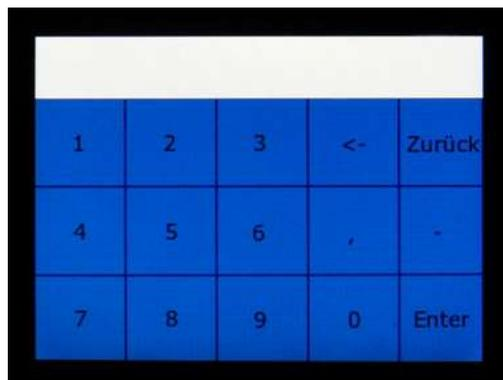
Die einzelnen Zahlenfelder müssen separat eingestellt werden. Die angezeigte Zahl muss zuerst mit dem ← Symbol gelöscht werden. Zahl eingeben und anschließend mit Enter bestätigen.
