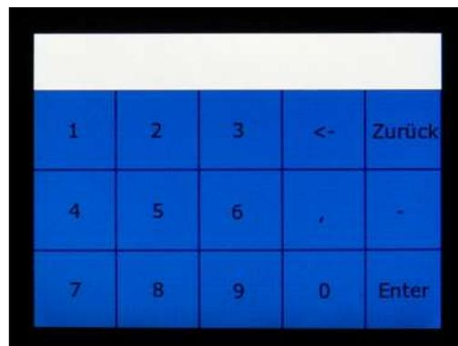
Die Kalenderwoche kann durch Drücken auf **KW** (linkes Feld) ausgewählt werden. Die angezeigte Zahl muss zuerst mit dem ← Symbol gelöscht werden. Dann die Zahl eingeben und anschließend mit Enter bestätigen. Das Jahr kann durch Drücken auf **Jahr** (rechtes Feld) gesetzt werden.
