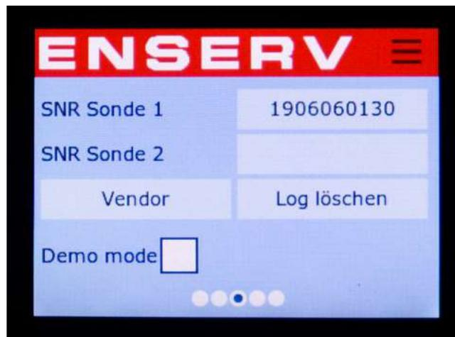
Die Seriennummer der entsprechen Sonde muss hier eingetragen werden. Diese wird mit der angeschlossenen Sonde verglichen und erst, wenn sie übereinstimmen, werden die Daten am NOXGUARD angezeigt und mitgeloggt.
