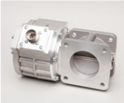
Die mit Stellgeräten kombinierten Drosselklappen von HEINZMANN können als Bestandteil der Motorregelung ideal eingesetzt werden. Als Drosselklappen steuern sie über die Gemischmenge Drehzahl und Leistung von Gasmotoren. In speziellen Anwendungen können sie als Gasventil auch zur Regelung von Gas-Luft-Verhältnissen verwendet werden. Alternativ sind sie außerdem noch als Turboby-passventile einsetzbar.
