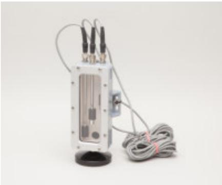
Die preiswerte Alternative zur Serie E: Gehäuse aus Aluminiumguss mit drei Kontakten. Dank der großen Sichtscheibe lässt sich der Ölstand auch visuell gut überwachen und die Einstellung der einzelnen Schaltpunkte wird erleichtert.
