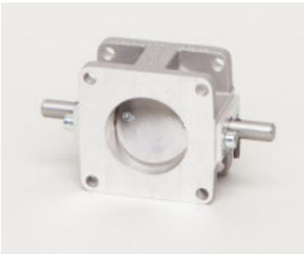
Als Bestandteil des Systems KRONOS 10 regelt die Drosselklappe über die Gemischmenge die Drehzahl und die Leistung des Gasmotors. In speziellen Anwendungen kann die Drosselklappe als Gasventil auch zur Regelung des Gas-Luft-Verhältnisses verwendet werden.
