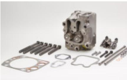
Die Ersatzteile wurden speziell für den Einsatz in Gasmotoren (Biogase) konzipiert. Sowohl der Guss des Zylinderkopfes als auch die Ventile und die Ventilsitzringe sind in der Legierungszusammensetzung optimiert. Zusätzlich wurde die Auslassventilführung verbessert, um den höheren Temperaturen entgegenzuwirken.
