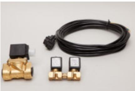
Mit geeigneten Magnetventilen werden die aufgeführten Regler zu einer Einheit ergänzt, die den Ölstand zwischen den Grenzwerten MIN und MAX überwacht und bei Abweichungen vom Sollwert frisches Öl nachfließen lässt. Angesteuert durch den Schwimmer-Magnetschalter öffnet das Magnetventil. Die Nennweite ist so ausgelegt, dass bei einer Zulauflhöhe des Reservebehälters von 1 m ca. 4 l/h nachfließen.
